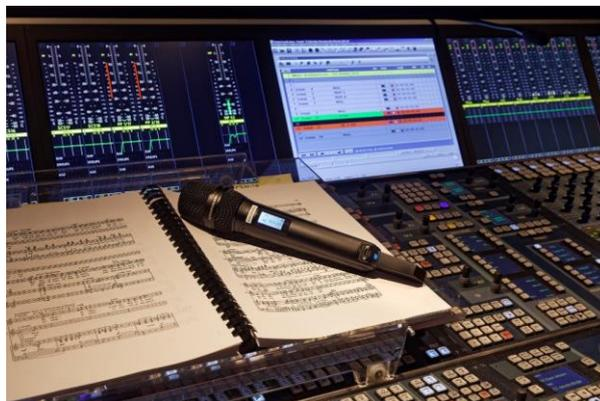
Jedes mit einer Netzwerkwerkschnittstelle ausgestattete Sennheiser Gerät ist mit einer eigenen IP-Adresse versehen, so dass Steuerung und Überwachung mithilfe der Sennheiser WSM-Software möglich sind. Der Wireless System Manager soll auch genutzt werden, um die Sennheiser L 6000 Ladestationen zu überwachen, sobald Letztere an ihrem endgültigen Standort eingebaut sind.
